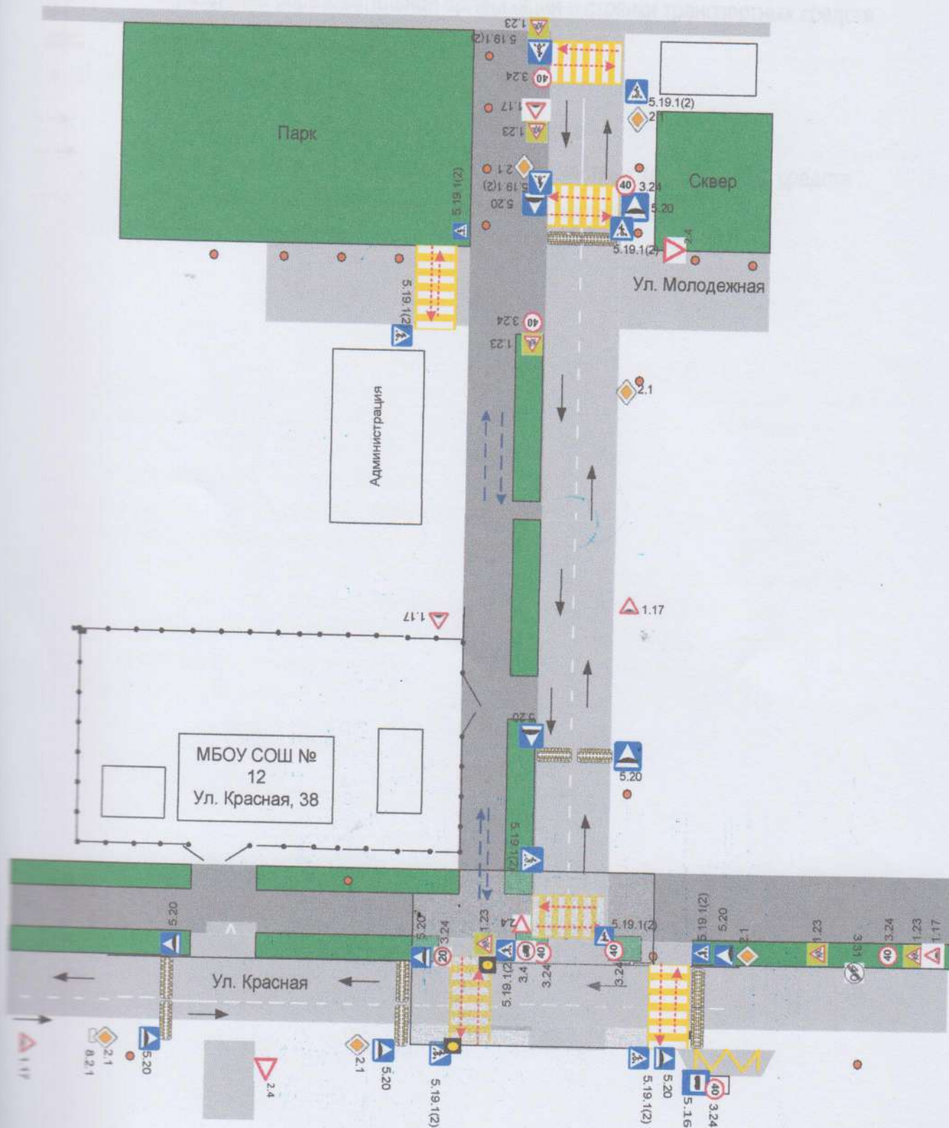
2. Схема организации дорожного движения в непосредственной близости от МБОУ СОШ № 12 с размещением соответствующих технических средств организации дорожного движения, маршрутов движения детей и расположения парковочных мест
